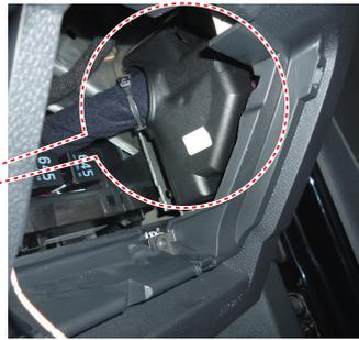
3. [2]で外したカバー内部の配線(黒/赤ライン)にボジスタップ(大)で接続します。(カプラーに接続されている配線の数などはグレード、装備などで変わることがあります。)
