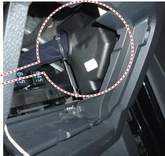
3. [2]で外したカバー内部の配線(黒/赤ライン)にボジタツプ(大)で接続します。(ケーブルに接続されている配線の数などはグレード、装備などで変わることがあります。)
