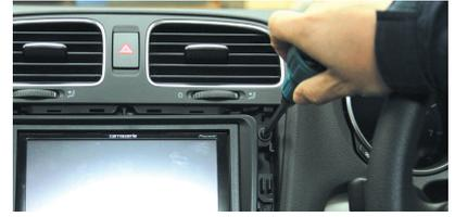
2. 純正カプラーにVXW本体カプラーを取付けます。(トルクスネジ×4)
