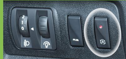
アイドリングストップ機能を一時的になくしたい場合に使用する純正スイッチです。このスイッチを押すとアイドリングストップ機能が停止(停車中でもアイドリングが継続します)します。ところが、このスイッチはエンジンをかけ直すと自動的にリセットされてしまうため、アイドリングストップが作動(停車中にアイドリングが停止)してしまいます。その為、**アイドリングストップが不要な人はエンジンをかけ直す度に、このスイッチを押さなければなりません。**
