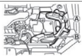
エアダクトを取り外すときは、接続部のツメなどを破損しないように注意してください。
