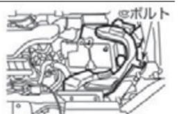
エアダクトの①部を外してから、②部を取外します。
