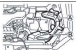
エアダクトを取外すときは、接続部のツメなどを破損しないように注意してください。
