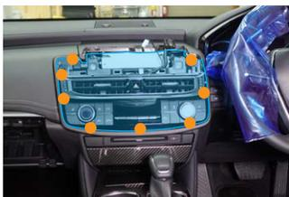
④下図の点線部分に内張剥がしを挿し込み、すき間に手を掛けて手前に引き、クリップのかん合を1か所外す。
