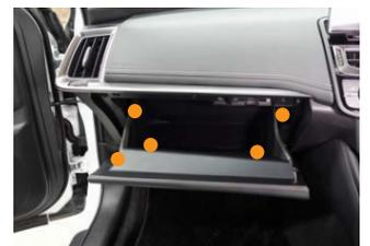
※グローブボックス内に配線を出すために、「HDMI延長ケーブル」と「USB延長ケーブル」をグローブボックス下のアンダーカバーSUB-ASSY裏からグローブボックス裏に通線する場合、ケーブルを通すためグローブボックスパネル内のパネルカバーに切加工をしてください。
