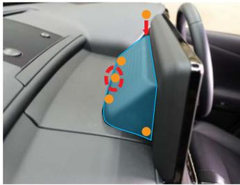
②純正モニターを固定しているボルト2本を外す。
