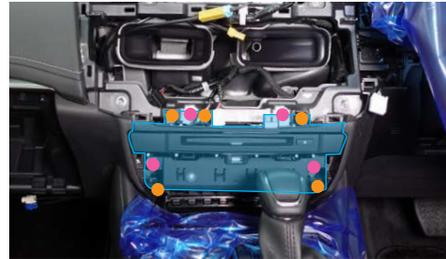
⑥グローブボックス下、アンダーカバーSUB-ASSYのパネルのサイドを持ち、下方に向けて取外す。(ツメのかん合6か所)
