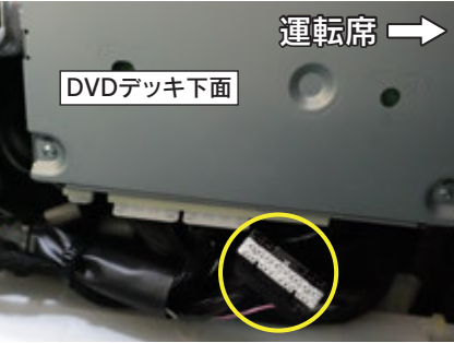
付属の車両接続用ハーネスの28ピンを取付ける
