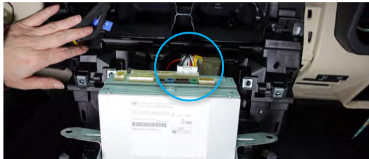
付属の車両接続用ハーネスの28ピンを取付け、他のケーブルは全て元に戻します。
