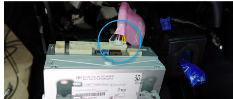
付属の車両接続用ハーネスの28ピンを取付け、他のコネクターは全て元に戻します。
