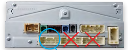
ケーブルAを接続するケーブル
