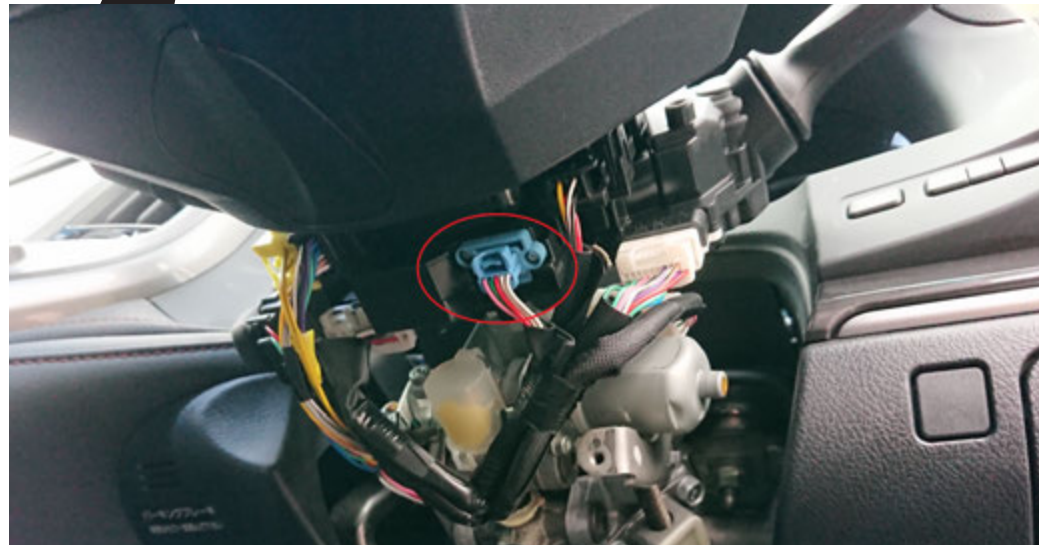
参考: 上記写真はクラウン210系(RAG01適合車両) ※ステアリングコラムカバーの取り外し方法、10ピンカプラー位置は車種によって異なりますので、お取付けになられる車種の情報は、お近くのディーラー様等へお問合せください。
