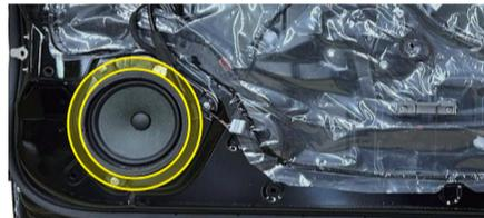
※注意: スピーカー内部の振動部分に黄色い部分に触れないように取り付けてください。
