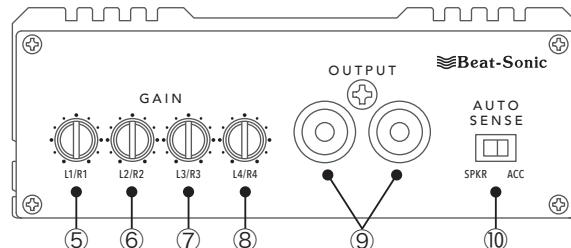
⑤フロントツイーター+フロントスコーカー調整（出荷時には車種別の調整が設定されています。）
