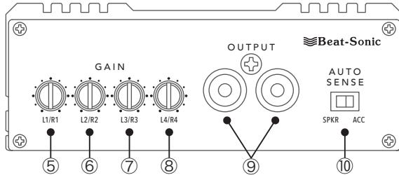
⑤サブウーファー調整 (出荷時には車種別の調整が設定されています。)
